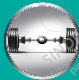
**Мосты:** жидкости для мостов, дифференциалов и бортовых редукторов. Обратите внимание, что для мостов с самоблокирующимся дифференциалом и управляемыми муфтами требуются специальные жидкости.
